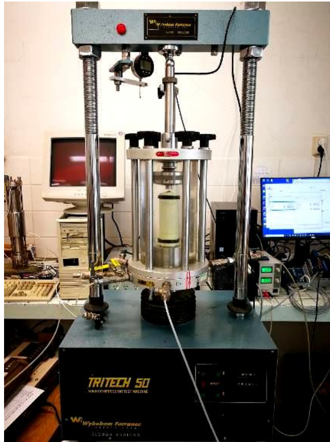
Obr. 4.2 Triaxiální smykový přístroj od firmy Wykeham Farrance.
