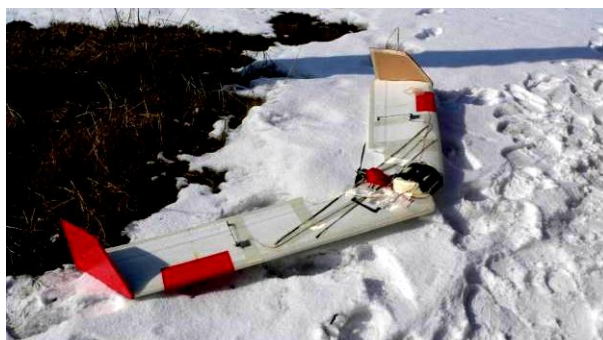
Obr. 2.11 Fixed-wing (Křídlo) – jeden z prvních modelářských UAV s digitálním fotoaparátem (2006).
