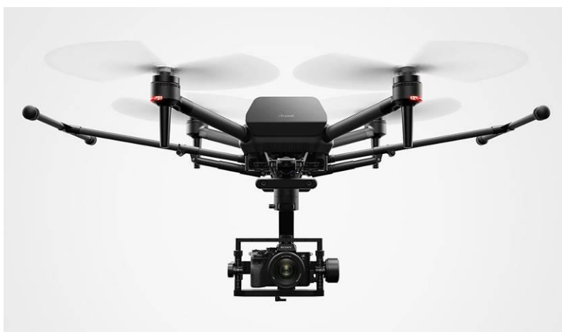
Obr. 2.9 Umístění gimbalu pod UAV. (Zdroj: www.dji.com )
