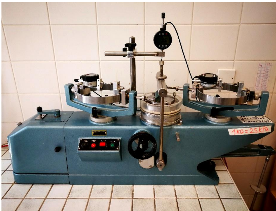
Obr. 4.3 Rotační krabicový přístroj typu Brohmead vyrobený firmou Wykeham Farrance.
