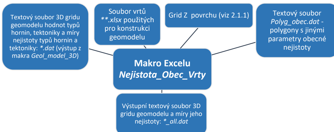
Obr. 7-1: Schéma vstupů a výstupů makra Nejistota_Obec_Vrty .
